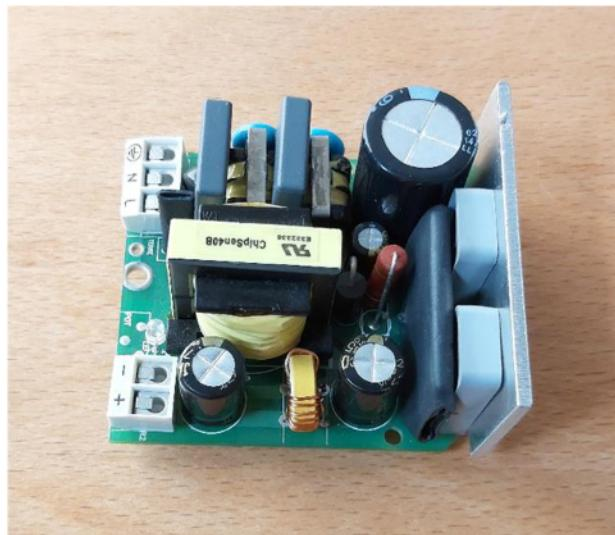
Le kit de conversion remplace : l'alimentation, le câble 230 V (2 m), le fil et la fixation de Terre, les deux fils 24 V, le support et le capot plastique.
