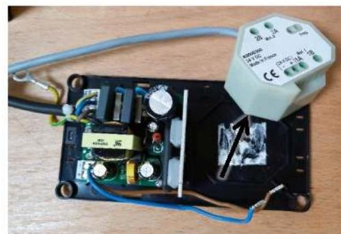
Pour les produits filaires, il faut séparer le câble d'alimentation et le câble de commande (avec des ciseaux).
