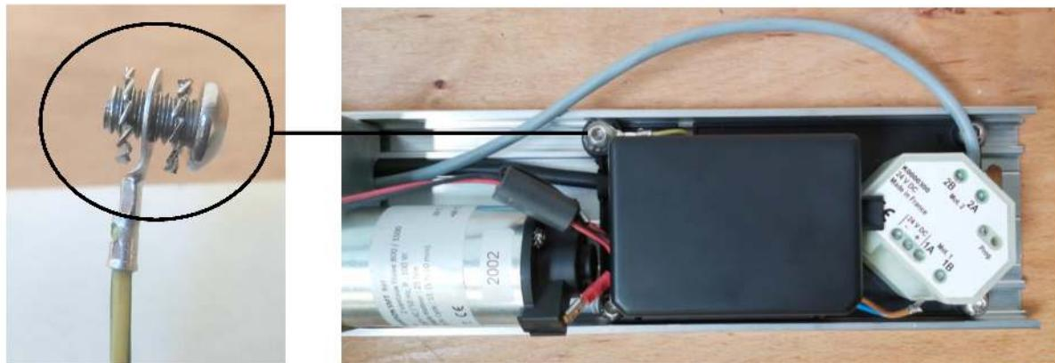
g. Placer le ou les câbles, et resserrer les 4 vis du motoréducteur.
