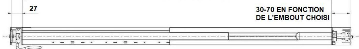
Une fois la dimension **E** mesurée sur l'installation, recouper les tube acier et Alu ZF54 à la dimension souhaité en fonction de l'embout de tube choisi (TRADI ou RENO).
